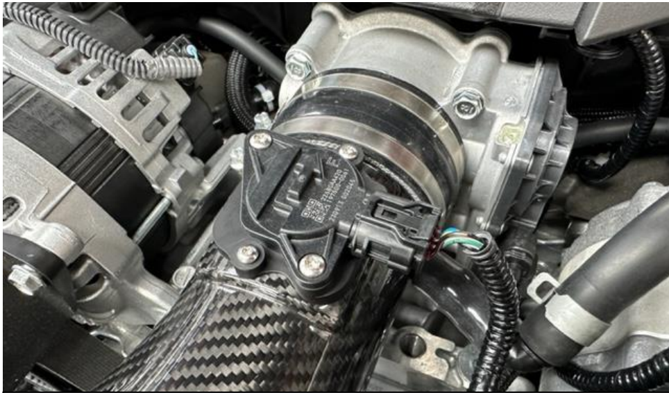
29. Reconnect the MAF sensor plug.
